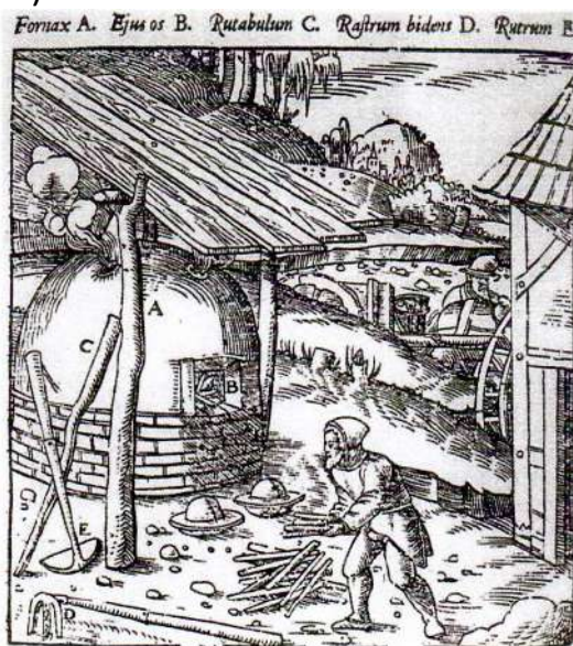
Forno a riverbero del XVI secolo (Agricola)
